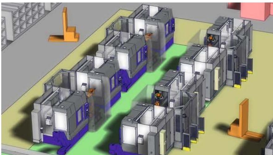
3 Zwei von in Summe vier Fertigungsinseln mit Industrieroboter
