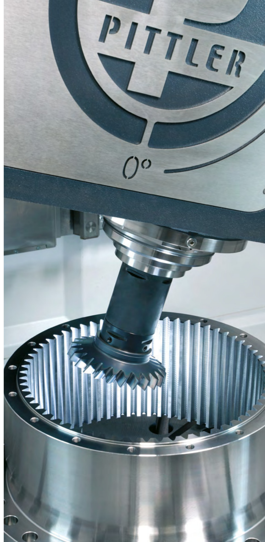
Einfache Programmierung des Wälzschäl-Prozesses Simple programming of the power skiving process
