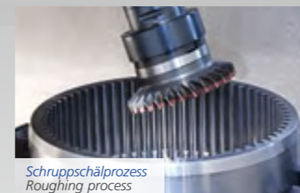
Schlichtschälprozess Finishing process
