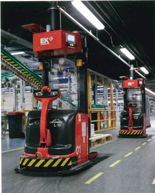
Bild 2: FTS System zum Transport der Werk- stückträger
