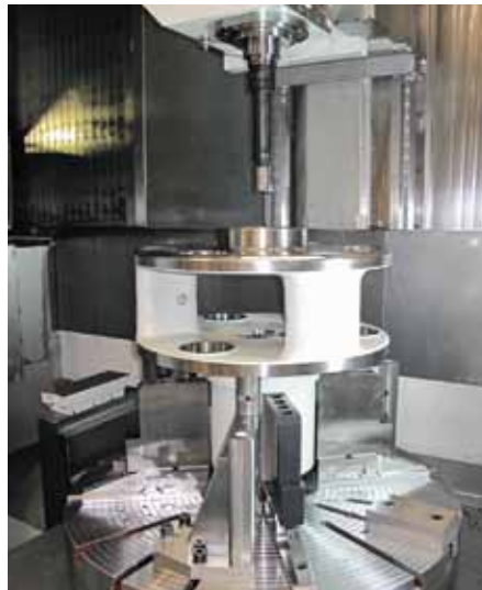
Bild 5: Der Planetenträger in zwei Einspannungen gebohrt, gefräst und gedreht.
