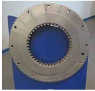
Bild 3: Das Zahnrad wurde inklusive der Innen- und Außenverzahnung aus dem Rohteil komplett auf einer Maschine bearbeitet.
