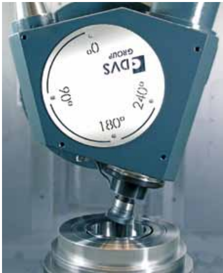
Bild 4: Multifunktionskopf beim Wälzschälen einer Innenverzahnung.
